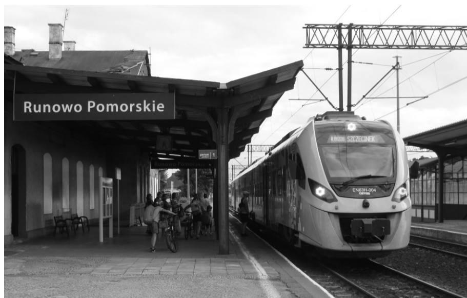
• Pociąg ze Szczecina do Szczecinka w momencie przełączania napędu elektrycznego na spalinowy przed wjazdem na niezelektryfikowaną linię Runowo Pomorskie – Szczecinek. Dwunapędowy tabor spalinowo-elektryczny także został wyłączony z dofinansowania unijnego.
