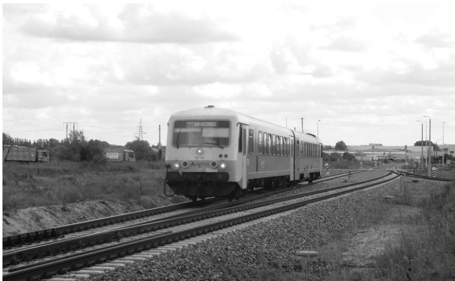
• Pociąg relacji Toruń Główny – Grudziądz zjeżdża z nowego odcinka dwutorowego, który powstał poprzez połączenie dwóch równoległe wybiegających z Torunia linii jednotorowych.
