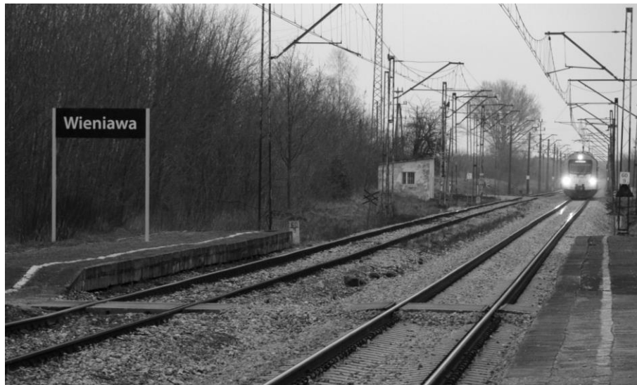
• Pociąg Kolei Mazowieckich relacji Radom – Drzewica wjeżdża na przystanek w Wieniawie. Skład EN57AKM porusza się lewostronnie wyremontowanym torem, na którym obowiązuje prędkość maksymalna 120 km/h. Na sąsiednim torze pociągi nie mogą przekraczać 60 km/h.
